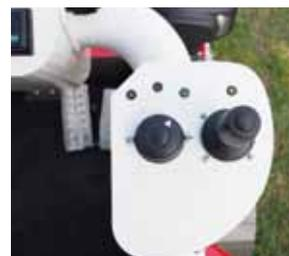
④ Fahrsteuerung mit elektrischem Regler für Geschwindigkeitsänderung. Hydraulikheber mit beweglicher Positionsregelung.
