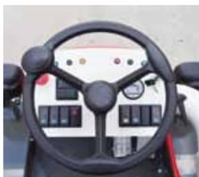
② Lenkradsteuerung mit einfacher Handhabung und einfachem Zugang. Display mit Strom- und Zeitanzeige in Echtzeit.
