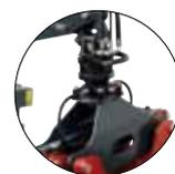
hydraulischer Rotator 4,5 to
